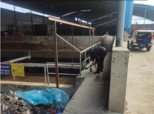
污水检测采样(废包装容器清洗废水)
