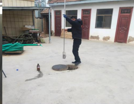
污水检测采样(生活污水)
