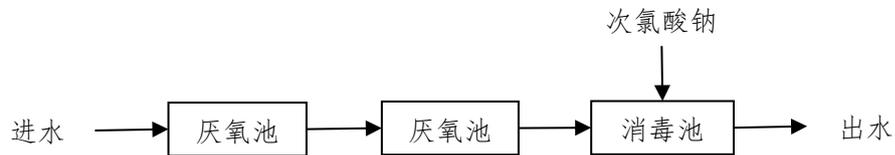
图 4-1 一体化污水处理工艺流程图
